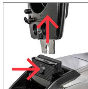
**2** Remova o cabo da alça vertical. Aperte o botão de liberação do cabo na base do cabo vertical e puxe o cabo vertical para cima e para fora da ranhura.
