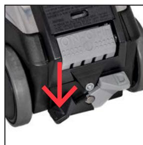
**2** Coloque a assistência de energia Tech Drive no neutro, pressionando o pedal esquerdo "N" (Neutro) para baixo.
