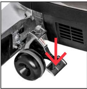
**7** Pressione o pedal inferior no "Toe-Touch Control" para baixo para elevar a parte dianteira da unidade.
