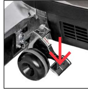
9 Pressione na seta para cima do "Toe-Touch Control" (pedal inferior) para baixo para elevar a parte dianteira da unidade.
