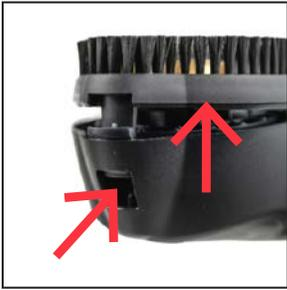
**2** Remova a turbina da ferramenta e remova quaisquer partículas ou fiapos da cavidade da turbina e da ferramenta.
