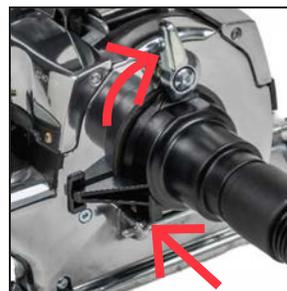
**5** Coloque os ganchos da Mangueira de Fixação sobre a Barra de Fixação e incline para cima até nivelar com a face da unidade. Gire a trava de acessórios no sentido horário para travá-la na posição. Abaixar a tampa da lâmpada de iluminação.
