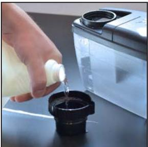
**15** O tanque de shampoo deve ser cheio ou esvaziado em uma pia. Desaparafuse a tampa grande na parte superior do tanque de shampoo. Gire a válvula de controle da espuma para a posição DESLIGADO. Encha o tanque com água morna (não quente) de acordo com o gráfico abaixo.
