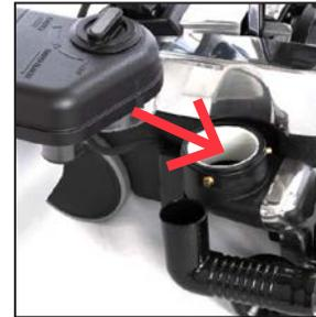
**17** Com cuidado para não derramar líquido na unidade ou no piso, coloque a abertura na parte inferior do tanque de shampoo sobre a porta de exaustão de ar.
